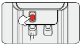
12. Установите на место крышку бака холодной воды в сборе. Откройте кран подачи воды в водораздатчик. Проверьте подачу воды из крана холодной воды. Если вода не течёт, нажмите, пожалуйста, кнопку для стравливания воздуха из бака холодной воды. Проверьте подачу воды из крана горячей воды. Вода должна идти непрерывной струёй.
