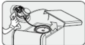
6. Извлеките распределитель холодной воды из бачка холодной воды, помойте и очистьте его.
